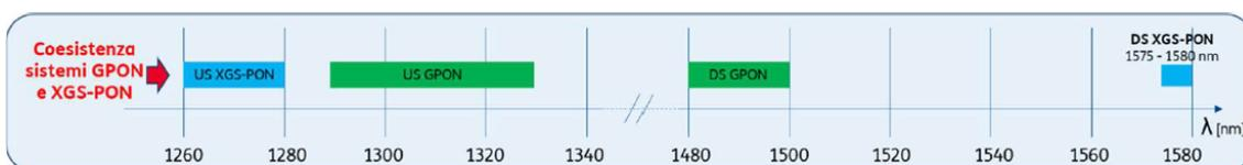
Figura 1 – Bande spettrali GPON e XGS-PON
