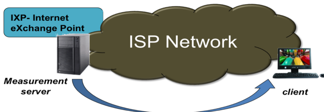
Figura 1 – Rappresentazione schematica dell'accesso fisico alla rete internet, oggetto della misura
