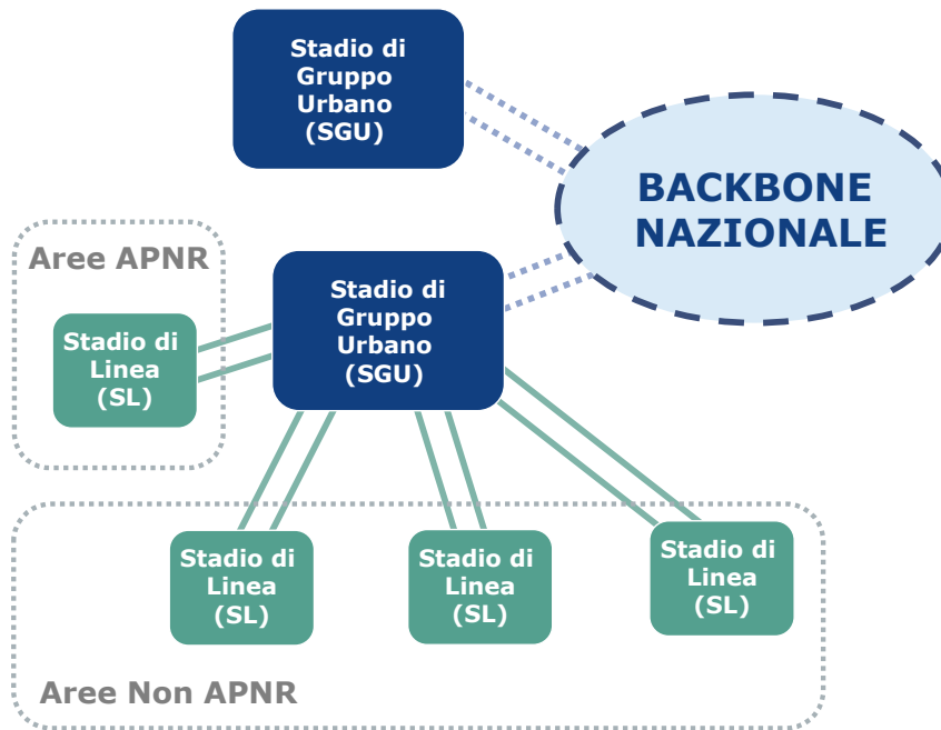
Illustrazione 11. Architettura della rete di accesso di TI
