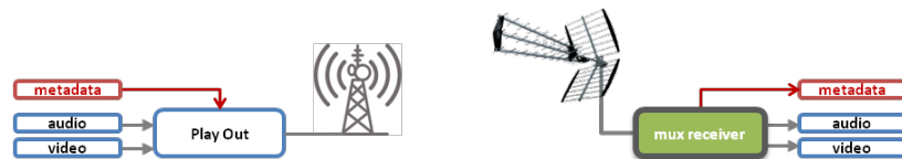
Figura 5 - Schema di trasmissione dei metadati (palinsesto) attraverso il TS
