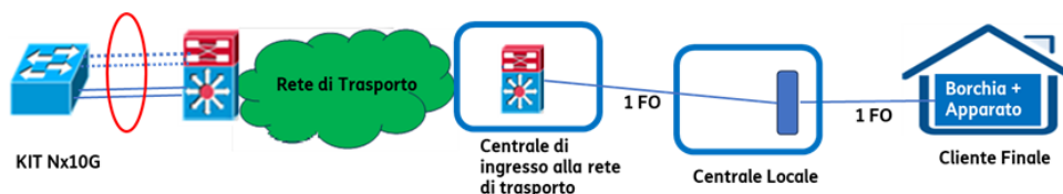
Figura 2.1: Schema impiantistico FTTO per velocità a 2 Gbps, 5 Gbps e a 10 Gbps con KIT Nx10G (porte a 10G logicamente affasciate)
