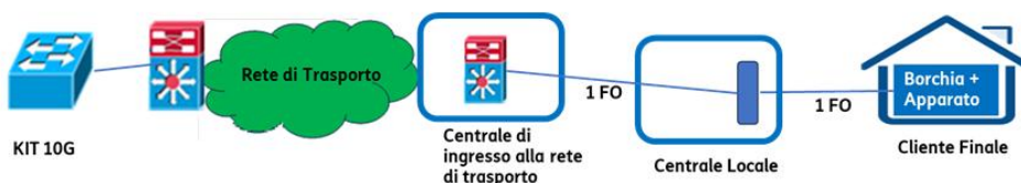
Figura 2: Schema impiantistico FTTO per velocità a 2 Gbps, 5 Gbps e a 10 Gbps con KIT base a 10G
