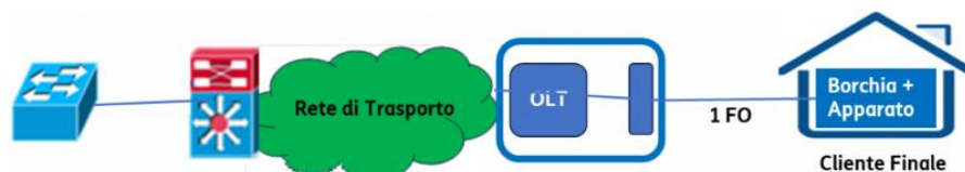
Figura 1: Schema impiantistico FTTO per velocità inferiori o uguali a 1 Gbps
