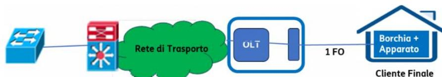
Figura 1: Schema impiantistico FTTO per velocità inferiori o uguali a 1 Gbps
