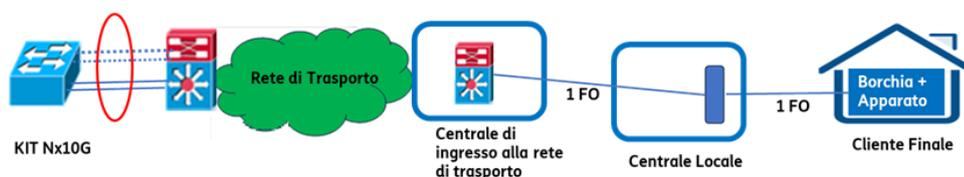
Figura 2.1: Schema impiantistico FTTO per velocità a 2 Gbps, 5 Gbps e a 10 Gbps con KIT Nx10G (porte a 10G logicamente affiancate)
